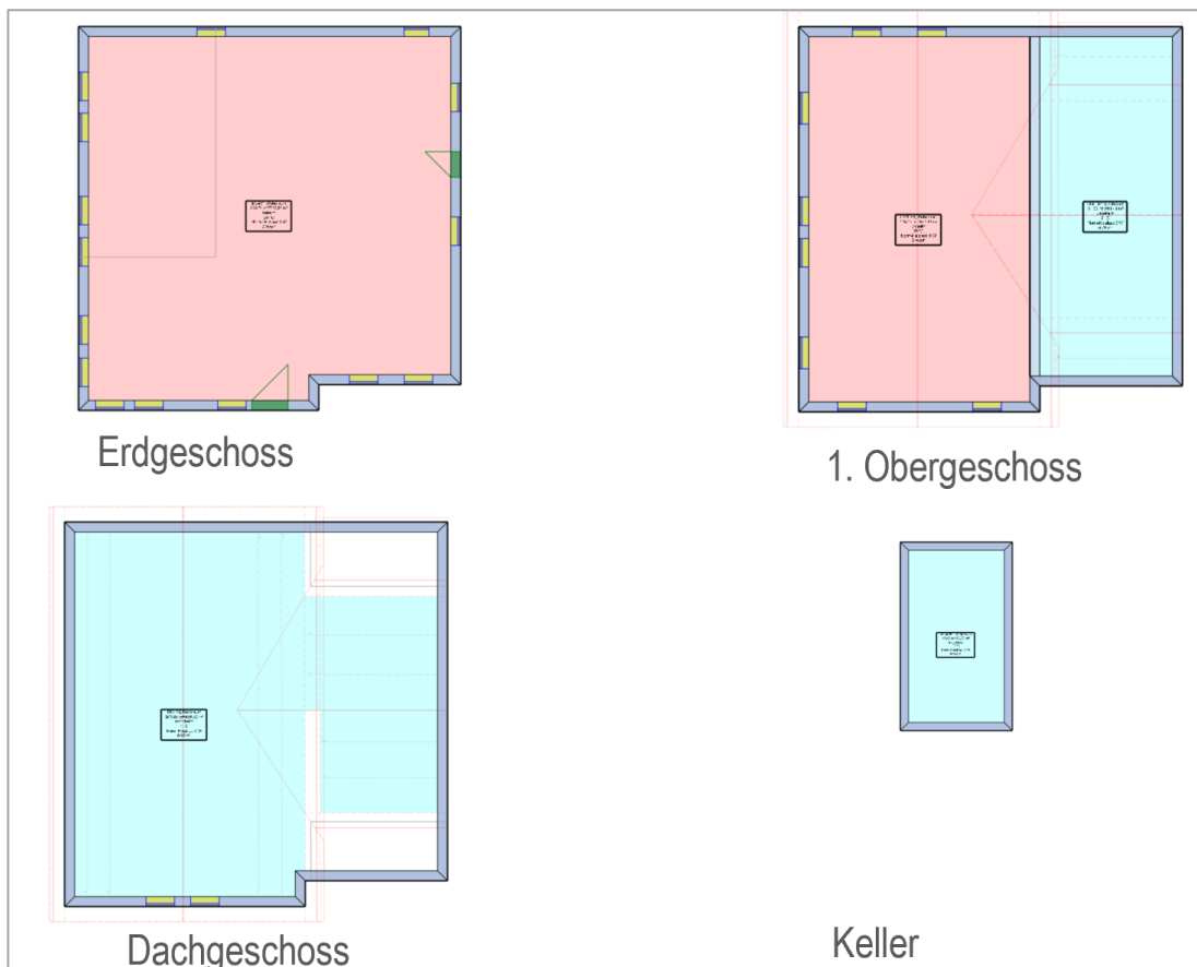
Abbildung 6-23: Thermische Gebäudehülle MSK 3
